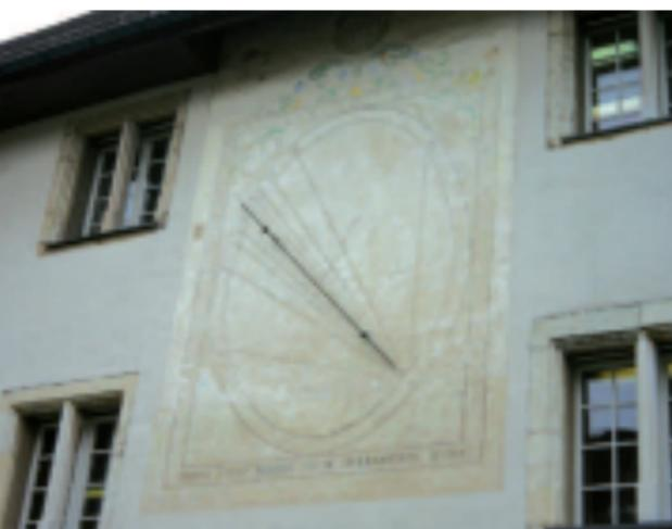
Die Vertikalsonnenuhr: Bei der Südsonnenuhr handelt es sich um einen Vertreter der vertikalen Sonnenuhren, deren Zifferblatt immer nach Süden ausgerichtet ist.
